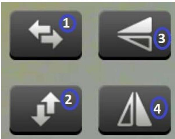
Premere **1** per ruotare la telecamera di sicurezza in senso orizzontale.
