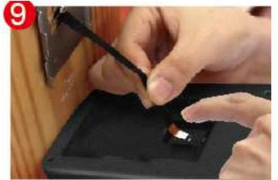
Raccordez la cosse du câble à l'embase de connexion (émetteur).
