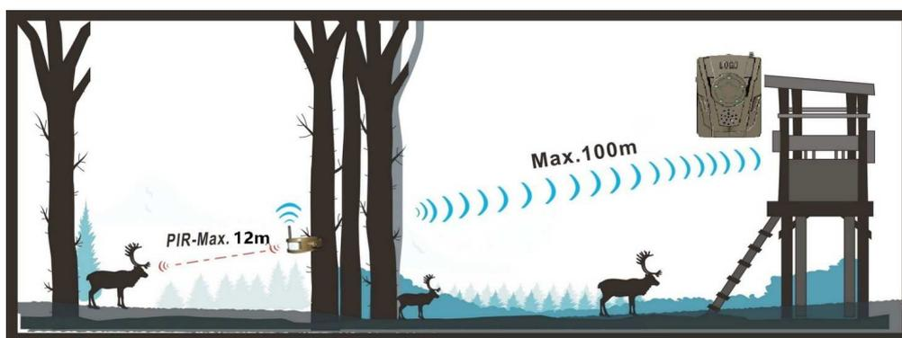
● Pour une détection optimale, il est recommandé d'installer le capteur à une hauteur de 0,3m à 2m du sol, et à une distance de 3m, 6m ou 9m de votre moniteur ou de la zone de détection, la distance de détection maximum étant de 12m sans obstacle.
